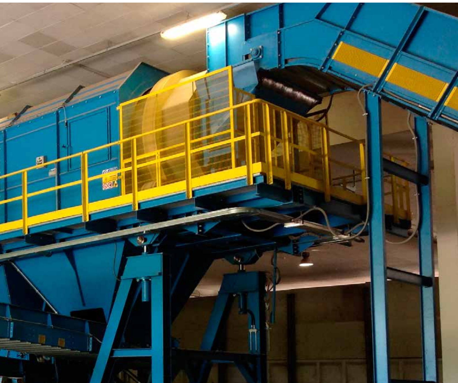
Vaglio rotante mod. VR8 2512 - Rotating screen mod. VR8 2512
